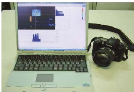
反射輝度測定用デジタルカメラ
